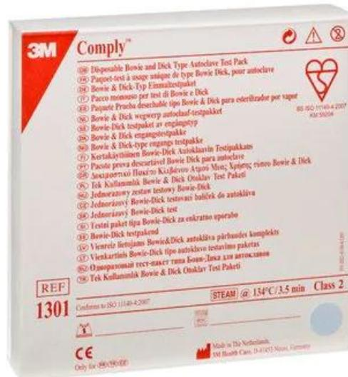
Paquet de tests Bowie Dick pour vérifier le fonctionnement de votre autoclave.
